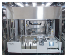
PET製剤の品質管理:自動品質検定システム
